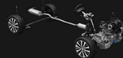
Được thiết kế giúp giảm ma sát ở các chi tiết hệ thống treo, hệ thống khung gầm cải thiện cảm giác cân bằng tay lái và gia tăng độ ổn định của xe.
