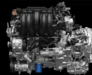
Động cơ 1.5L i-VTEC DOHC với công suất cực đại 119Hp/6.600rpm và mô men xoắn cực đại 145Nm/4.300rpm cho khả năng tăng tốc nhanh và mạnh mẽ, đồng thời giúp tiết kiệm nhiên liệu tối ưu.
