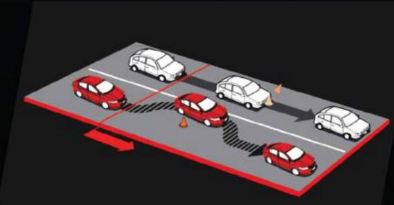
Hệ thống chống bó cứng phanh (ABS), phân phối lực phanh điện tử (EBD) và hỗ trợ phanh khẩn cấp (BA) giúp xe an toàn trong những tình huống phanh khẩn cấp.
